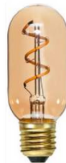
M45mm N108mm 2700K 80Ra200lm360 4w (≈19W) E27 220-240VAC EC A+
